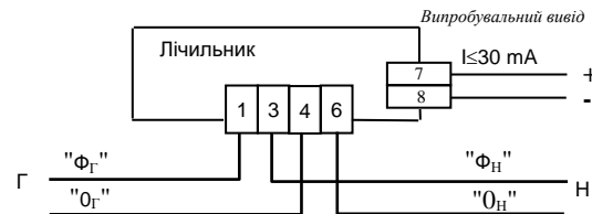
Рисунок 2 - Схема підключення лічильника СЕ102-У в корпусі S7
