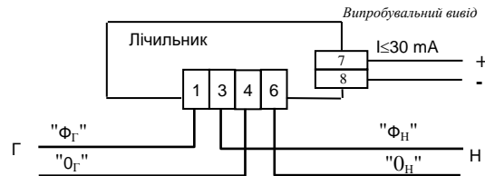
Рисунок 2 - Схема підключення лічильника CE102-U в корпусі S7
